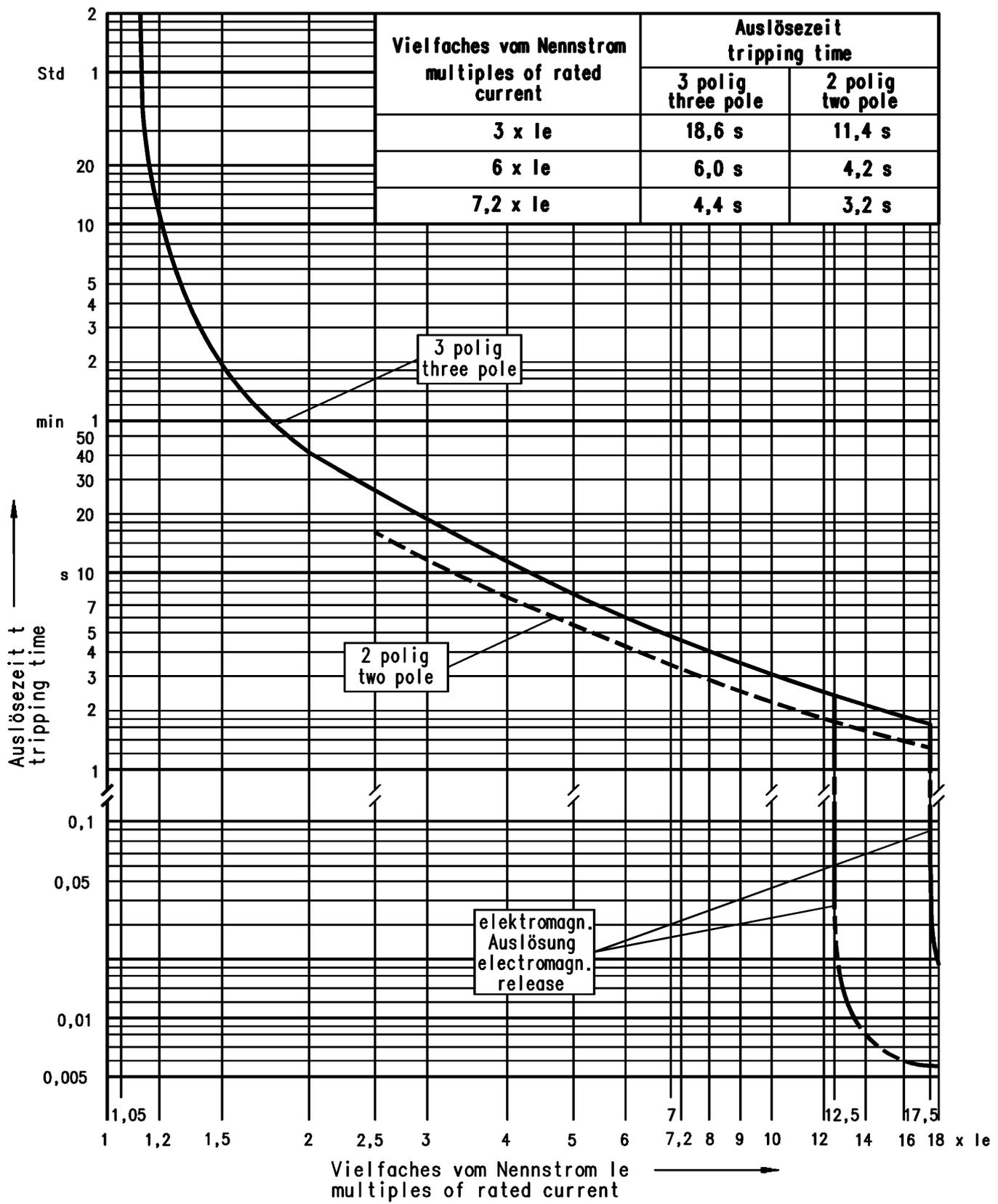
**Auslösekennlinie (aus kaltem Zustand)**
